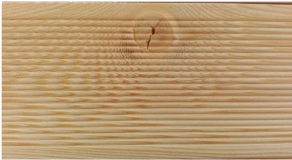
Fot. 13 - sęk spękany, niewykruszony
