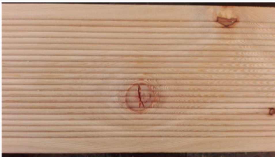
Fot. 21 - sęk spękany, wykruszony
