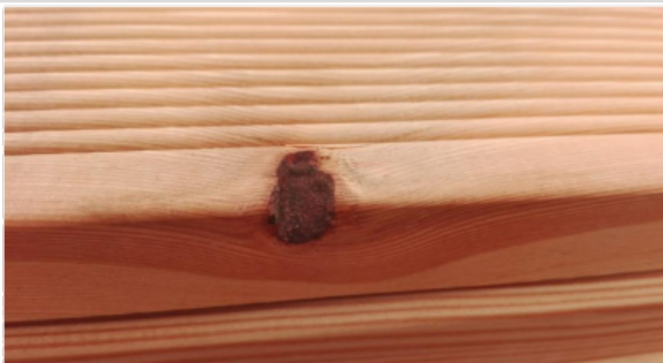
Fot. 14 - sęki boczny wypadnięty
